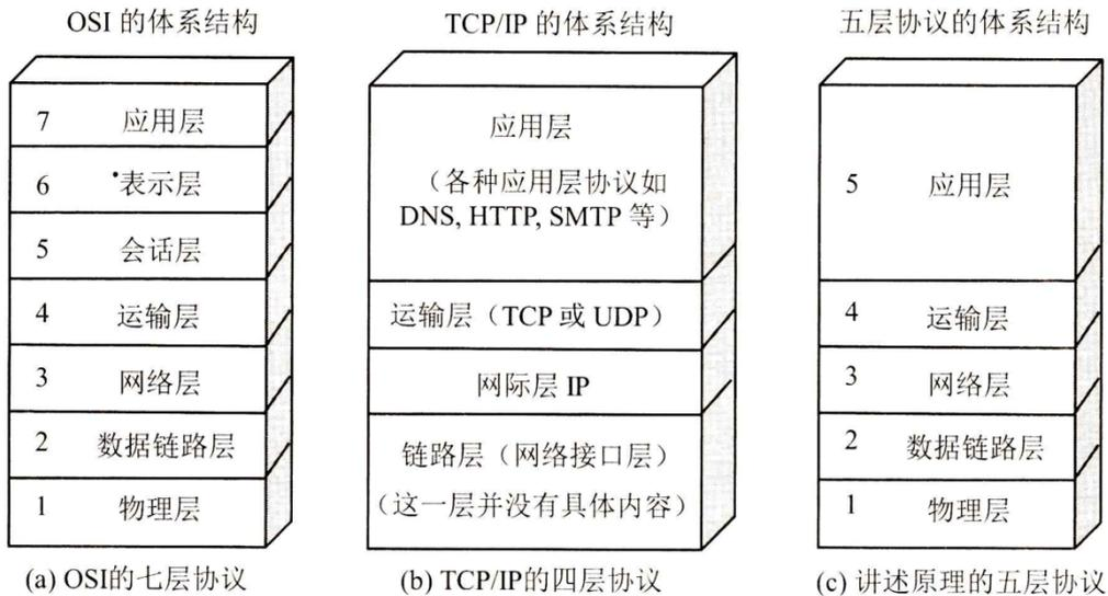
图 1-16 计算机网络体系结构
